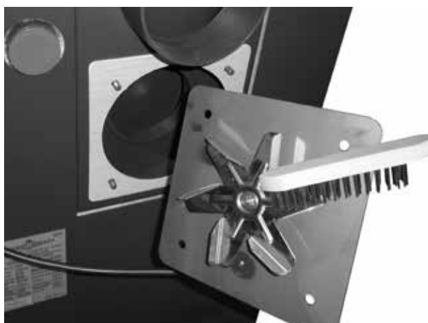
Oczyszczanie koła obiegowego wentylatora spalinowego - kontrola stanu łopatek (oprócz D10PX)
