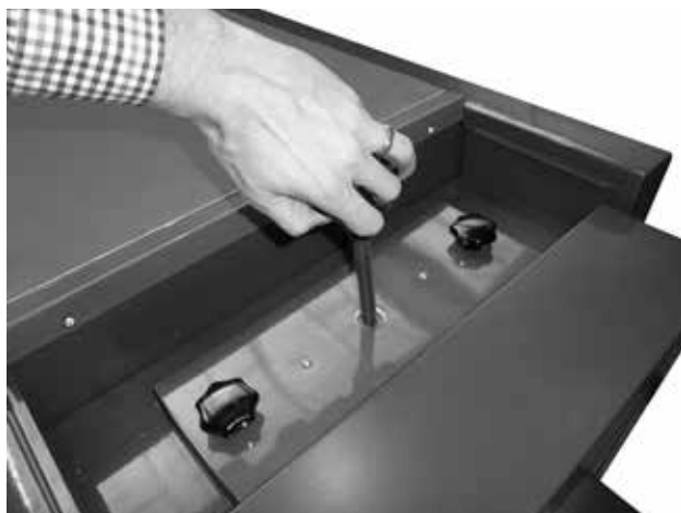
Ilustracja czyszczenia roboczego wymiennika rurowego i zwalniczy z wymiennika rurowego i zwalniczy krótkimi ruchami w górę i w dół
